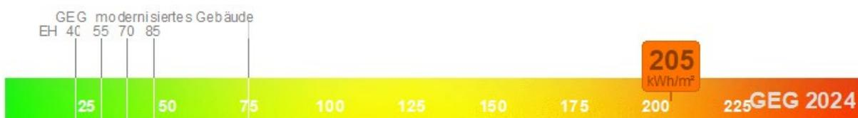
Abbildung 19 | Primärenergiebedarf des betrachteten MFH nach DIN V 18599
