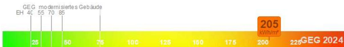
Abbildung 18: Primärenergiebedarf des betrachteten MFH nach DIN V 18599
