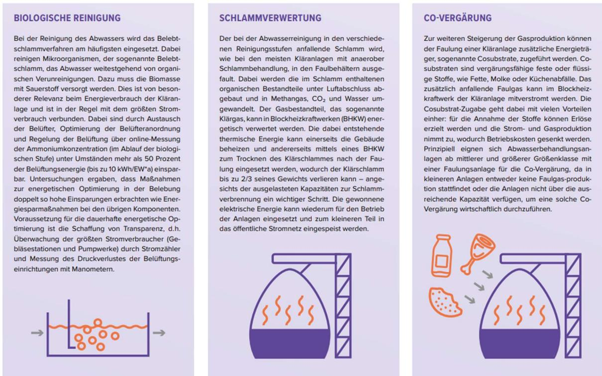
Abbildung 21 | Hauptpotenziale zur Steigerung der Energieeffizienz von Kläranlagen (Quelle [14])
